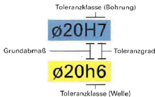
Abbildung 2, ISO Bezeichnung einer Welle und einer Bohrung für das Nennmaß 20
